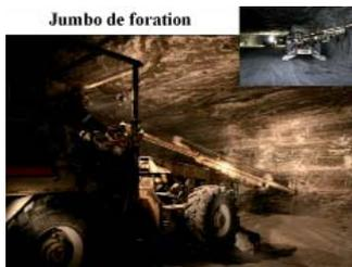
Pour préparer les tirs, on utilise un jumbo de foration. Il permet de percer des trous de 4,50 mètres de profondeur sur un diamètre de 4 centimètres pour placer l'explosif. Il en faut 42 par tir. Chaque tir permet un abattage de 500 à 600 tonnes de sel.
