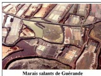
Dans les marais salants, c'est la mer qui fournit une saumure, évidemment moins concentrée en sel que celles issues de pompages ! L'eau de mer est introduite dans des bassins à marée haute. Le sable sédimente. La chaleur du soleil fait évaporer l'eau et progressivement, le sel se dépose sur le fond du bassin. En le raclant, on récolte au plus 28 grammes de sel par litre d'eau de mer.
