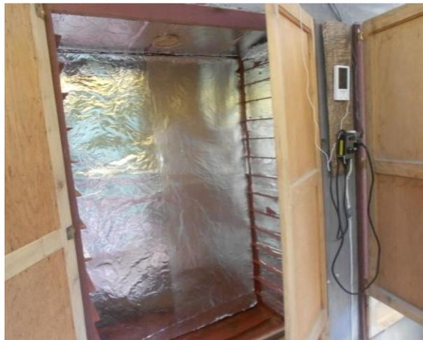
Photo 39.- Vue de l'intérieur du séchoir à air chaud par conduite forcée; Terra Magica - Sud-Est
