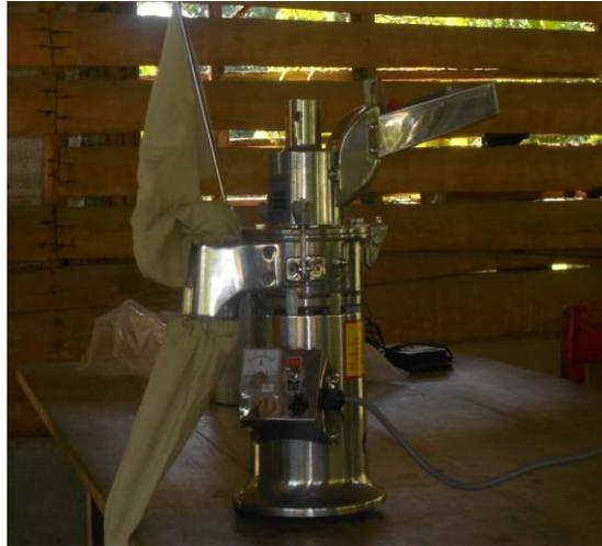
Photo 44.- Moulin électrique utilisé pour la fabrication de poudre de Moringa- Terra Magica, Cayes Jacmel - Sud-Est
